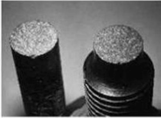
الكسر الهش لمعدن قصيف مثل الحديد
